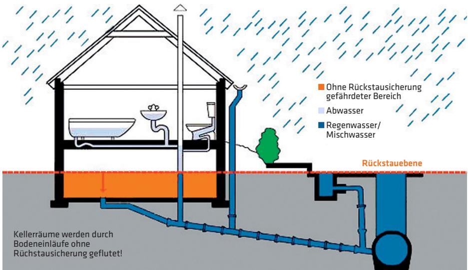
Bei hoher Auslastung des öffentlichen Kanals steigt der Wasserspiegel im Kanalrohr bis über die Höhe des Kellerfußbodens. Wenn es jetzt ungesicherte Abläufe oder undichte Stellen in den Rohren gibt, tritt das Wasser in großen Mengen im Keller aus.
