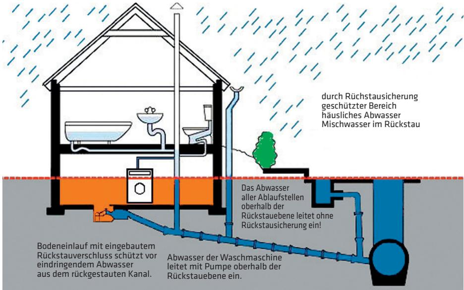
Besser ist der Einbau nur einer automatisch schließenden Sicherung an der Stelle, wo die Grundleitung das Haus verlässt.
