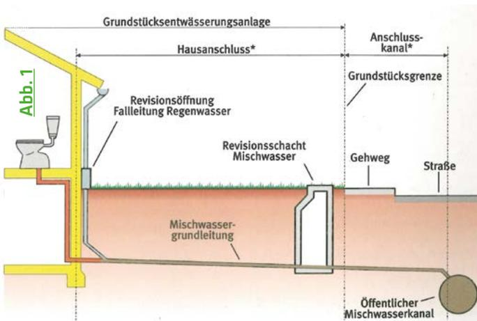
Die Mehrheit des Friedrichsthaler Kanalnetzes sind Mischsysteme. Das heißt es gibt nur ein Leitungsnetz, das Schmutzwasser, also häusliches und gewerbliches Abwasser, zusammen mit Regenwasser zur Kläranlage abführt.
